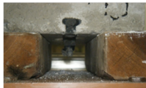
補修材料の破壊直後の様子
