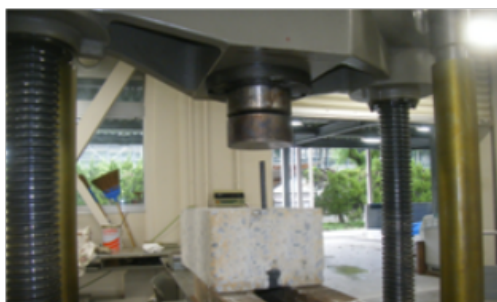
万能試験機を用いた 押し出し実験の様子
